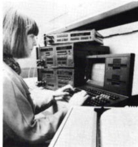
Afb. 9. Opstelling voor automatische kalibratie via IEEE488-bus, bestaande uit een besturingscomputer en de kalibratoren 4000 en 4200 (foto: Datron Instruments Ltd.).
